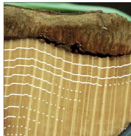
Abb. 4: Holzdeformierung bei Buche
